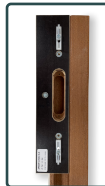
Afb. 6 - Mal in kozijn
