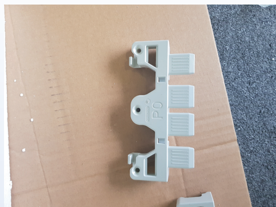
16: Plastic boven profielen om de staanders aan de rail te bevestigen. Schuif dit in de staanders
