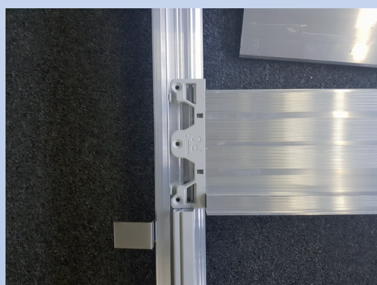
18: Blijf de plastic bovenprofielen in de rail duwen tot er een klik te horen is.
