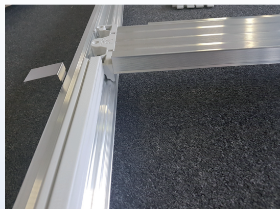
19: Blijf de plastic bovenprofielen in de rail duwen tot er een klik te horen is.
