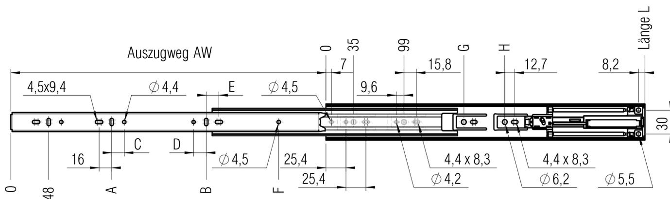
Anschraubbohrungen für 3,5 mm Spax-Schraube
